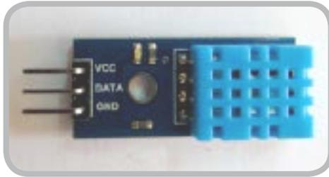
1. Sensor de Humedad y Temperatura DHT11
